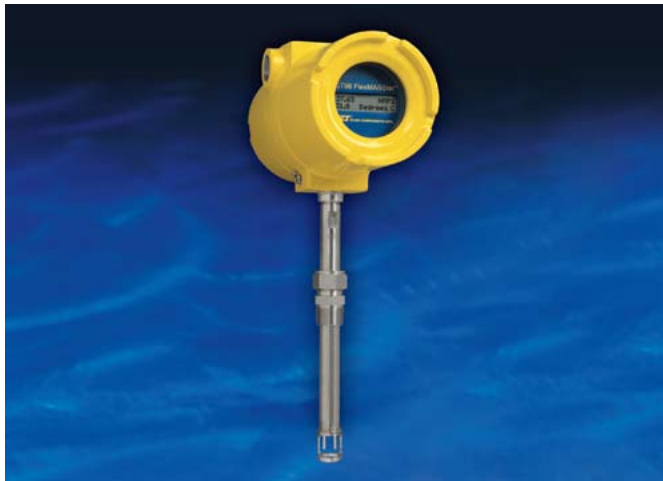
El modelo ST98 es un medidor de flujo tipo inserción para tamaños de tuberías que van de 64 mm a 1066 mm [2 1/2" a 42"]. El margen de calibración típico va de 0,21 NMPS a 172 NMPS [0,75 a 600 pies 2 /s]. 1
